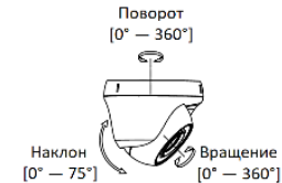
Рисунок 1-15 Настройка угла наблюдения камеры
