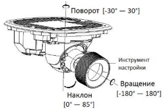
Рисунок 1-23 Настройка угла наблюдения камеры
