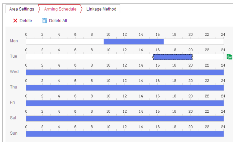
Рисунок 5-14 Настройка расписания постановки на охрану
