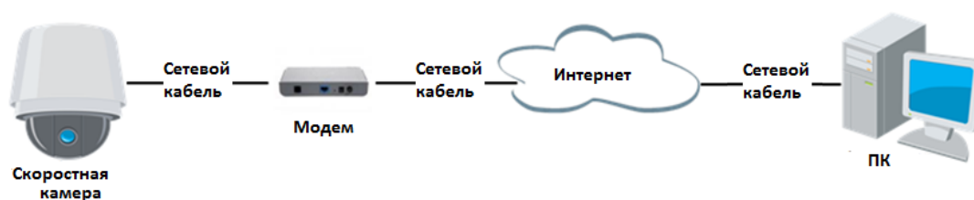
Рисунок 2-12 Доступ к камере с динамическим IP-адресом
