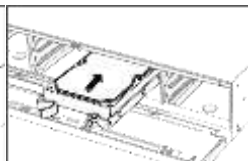
Рисунок 2-9 Вставьте жесткий диск
