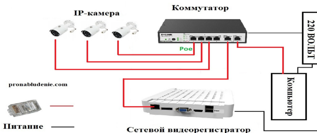
Схема подключения камер по режиму PoE.
