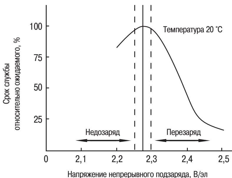
Рис. 13 Зависимость срока службы аккумулятора от напряжения подзаряда.
