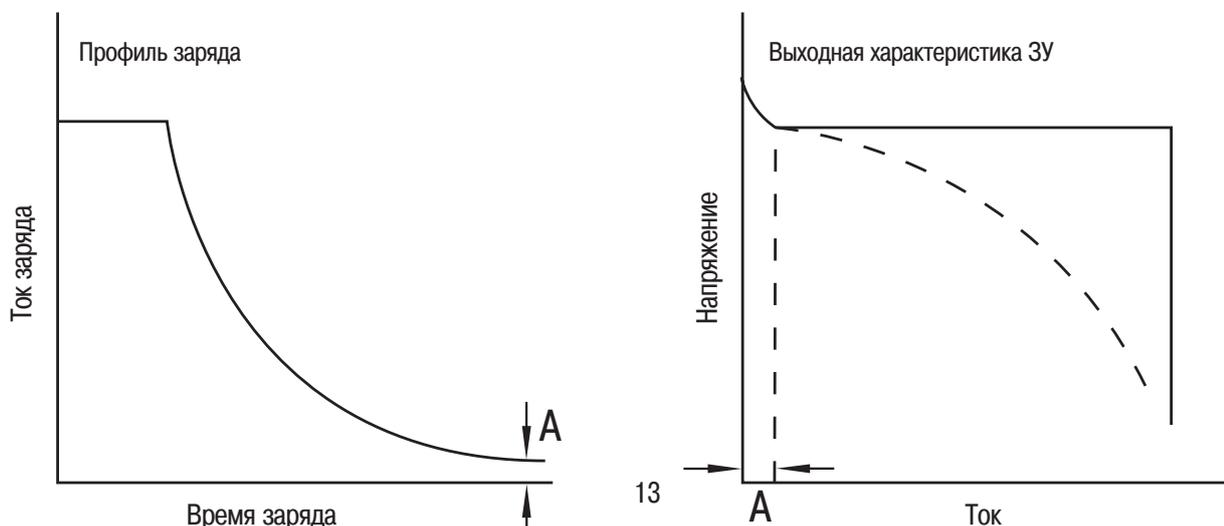
Рис. 8 Зарядная характеристика и выходная характеристика зарядного устройства.
