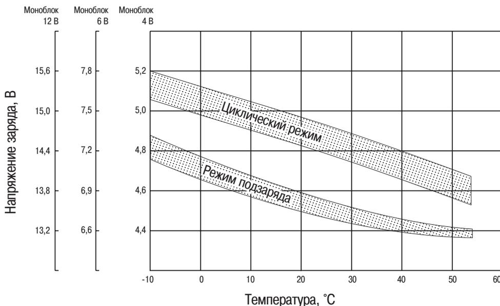
Рис. 10 Соотношение между напряжением заряда и температурой.
