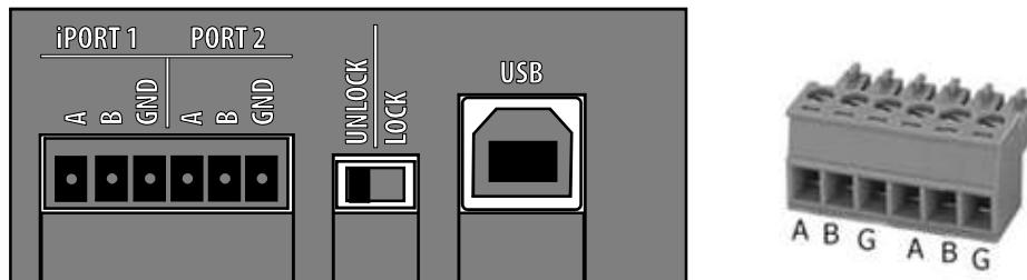
**iPORT1** - разъём для подключения к гальваноразвязанной линии №1 RS-485.
