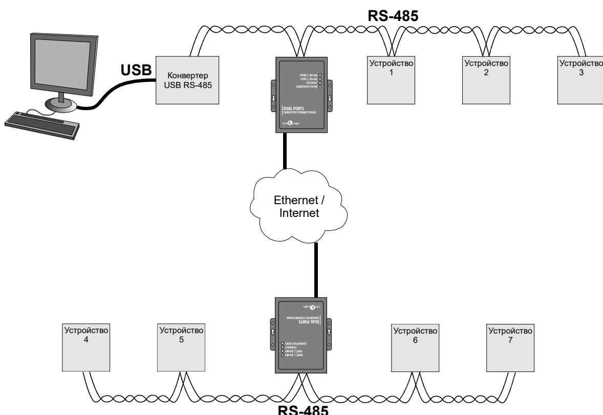
Пример конфигурации конвертеров для режима моста:
