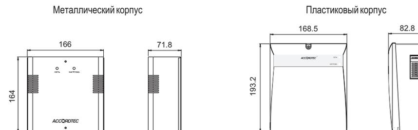
Блок питания обеспечивает зарядку аккумуляторной батареи емкостью 7А<sup>ч</sup>., устанавливаемой потребителем в корпус источника током до 1,0А и поддерживает ее в заряженном состоянии при наличии сетевого напряжения (~) от 110В до 250В.
