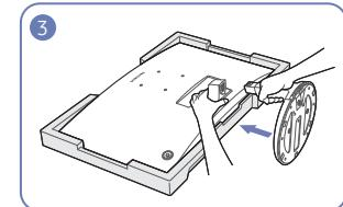
Положите на пол защитный пенопластовый материал (стиропор), входящий в комплект, и разместите на нем устройство экраном вниз, как показано на рисунке.
