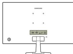
— Функция воспроизведения звука не поддерживается, если устройство подключается с помощью кабеля HDMI-DVI.
