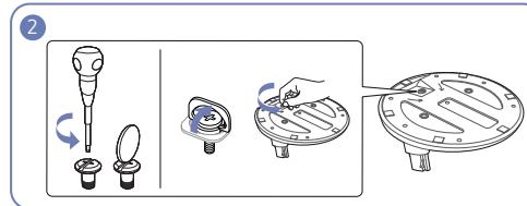
Открутите соединительный винт в нижней части подставки.
