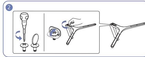
Открутите соединительный винт в нижней части подставки.
