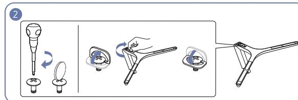
Полностью закрутите соединительный винт в нижней части подставки, чтобы как следует зафиксировать соединительный элемент.
