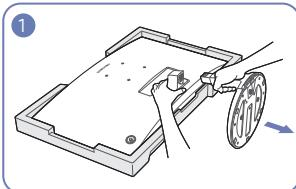
Положите на пол защитный пенопластовый материал (стирофон), входящий в комплект, и разместите на нем устройство экраном вниз, как показано на рисунке.
