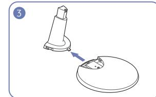
Извлеките соединительный элемент из подставки, потянув его в направлении стрелки, как показано на рисунке.
