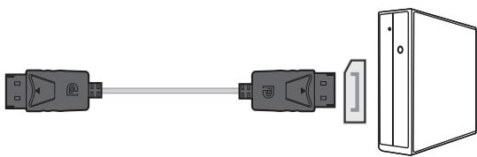
— Рекомендуется использовать кабель DP длиной до 1,5 м. Использование более длинного кабеля может повлиять на качество изображения.
