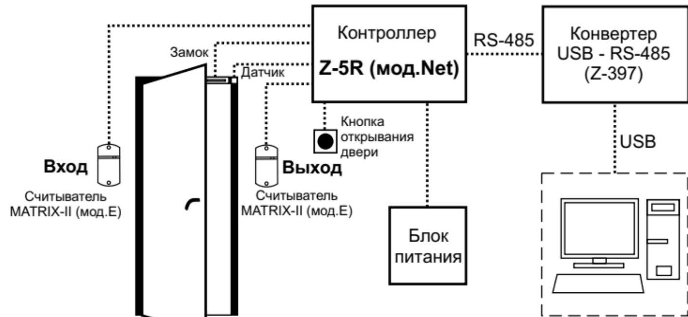
Рис.1 Схема СКУД с контроллером Z-5R (мод.Net)
