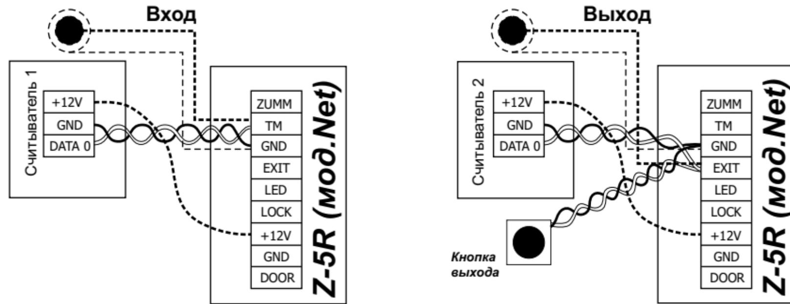
Рис.3 Подключение считывателей к контроллеру по протоколу iButton
