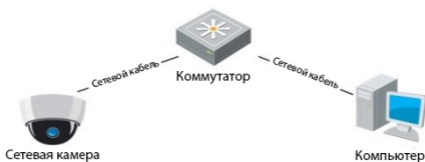
Рисунок 3-2 Соединение через коммутатор или роутер
