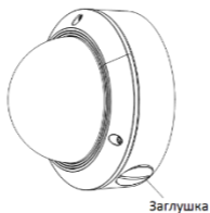
Рисунок 2-17 Расположение бокового отверстия
