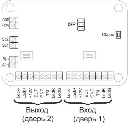
+12V – напряжение питания GND – общий провод
