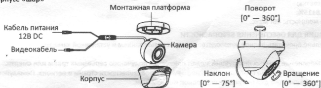
Рисунок 2 Описание камеры в корпусе «шар»
