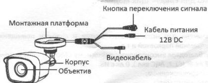
Рисунок 1 Описание цилиндрической камеры
