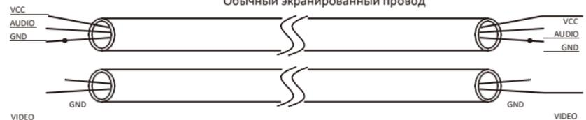
Режим подключения обычного неэкранированного кабеля 3C + видеокабеля (RG-59)
