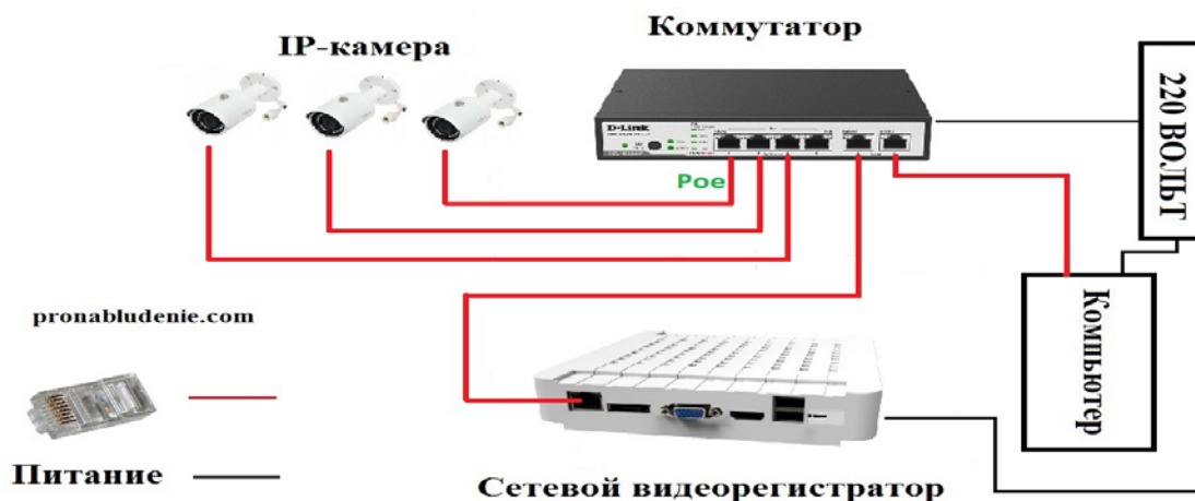
Схема подключения камер по режиму PoE.
