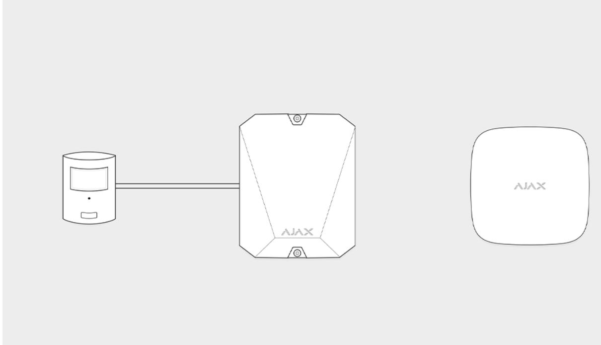
MultiTransmitter можно использовать для подключения тревожных и медицинских кнопок, датчиков движения для помещений и улицы, а также датчиков открытия, вибрации, разбития, возгорания, газа, протечки и других. Тип устройства указывается в настройках зоны. От выбранного типа зависит текст уведомлений о тревогах и событиях подключенного устройства, а также коды событий, передаваемые на пульт централизованного наблюдения охранной компании (ПЦН).
