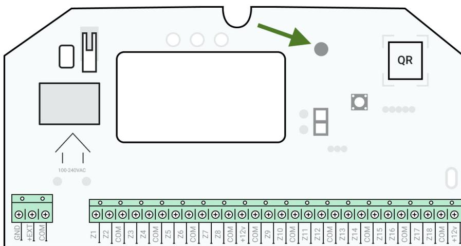
Световой индикатор MultiTransmitter может гореть белым, красным или зеленым цветом, в зависимости от состояния устройства. Учитывайте,
