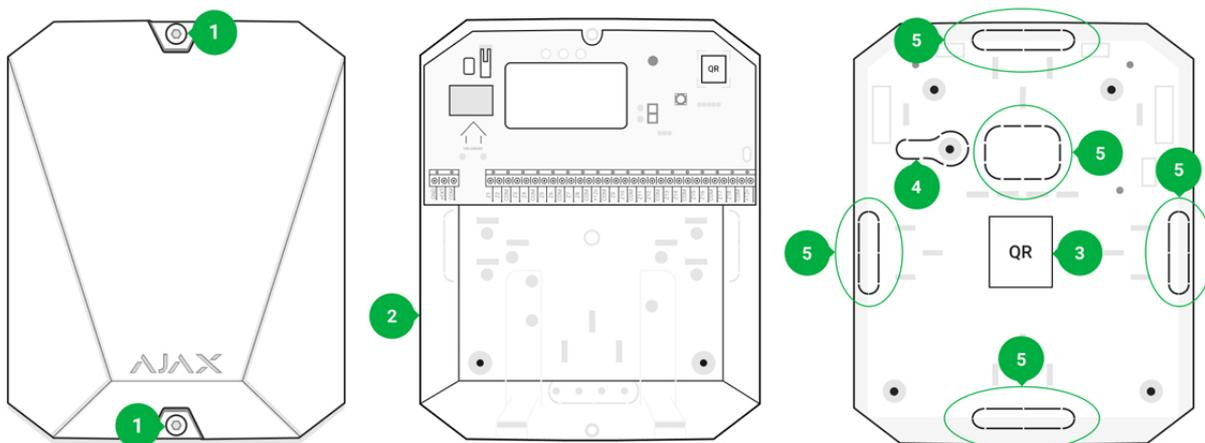
1. Винты, фиксирующие крышку корпуса. Откручиваются комплектным шестигранником (Ø 4 мм)
