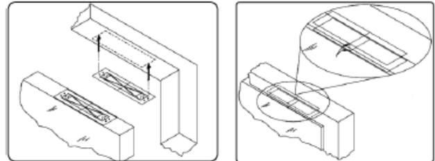
Шаг 3. Просверлите отверстия согласно шаблону и сделайте отверстие для индикатора.
