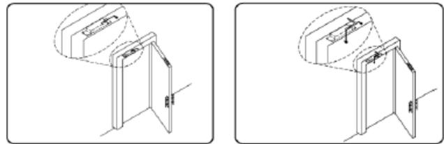
Шаг 5. Подключите замок, задайте время задержки и зафиксируйте замок и якорь.
