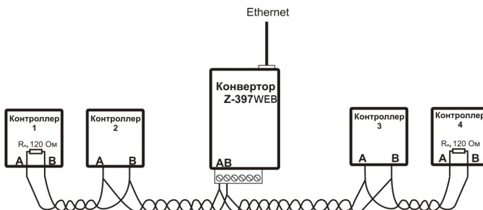
Пример схемы подключения конвертера в середине линии RS485. Нагрузочное сопротивление подключать не требуется
