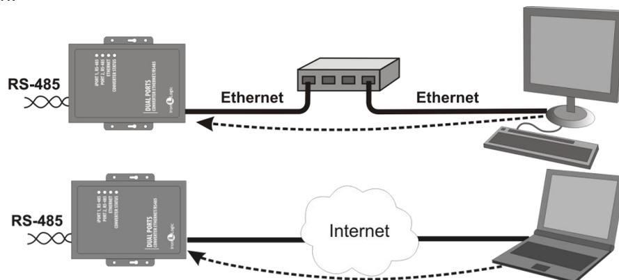
Этот режим удобно использовать, когда известен IP адрес конвертера или структура и настройки сети позволяют программному обеспечению обнаруживать конвертер. Также преимуществом данного режима является возможность подключения к конвертеру с разных компьютеров, как находящихся в локальной сети, так и по сети Internet.
