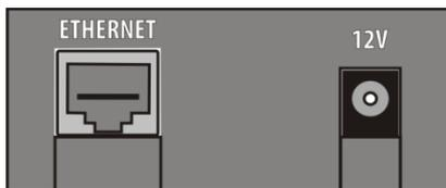
**ETHERNET** - Разъём RJ45 для подсоединения к локальной сети. Для подключения используется стандартный патч-корд с прямым порядком обжима.
