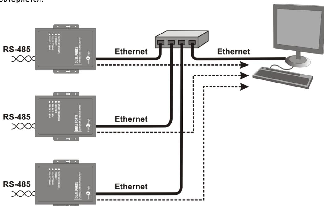
В данном режиме работы нет необходимости знать IP адреса всех конвертеров, входящих в систему. Каждый из них будет соединяться с одним сервером самостоятельно. При этом нет возможности перенести сервер на другой компьютер без переконфигурирования всех конвертеров.
