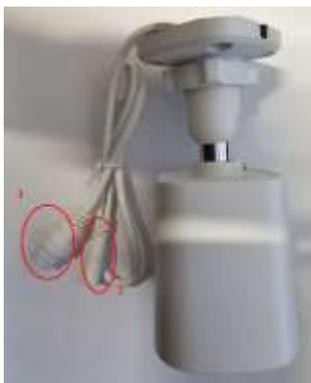
разъем № 1 – LAN порт (сетевой порт), предназначен для подключения камеры к видеорегистратору, либо устройству коммутирования;
