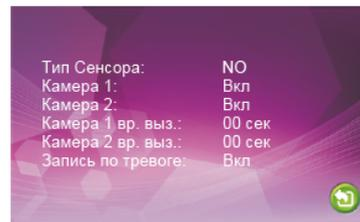
[Тип сенсора]: Каждая камера имеет функцию записи по датчику движения. Когда датчик движения замкнёт контакты, то запись в домофоне активируется, в зависимости от настройки домофона по записи клипа или снимка.
