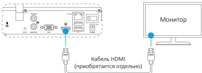
**i** Выберите соответствующий источник сигнала монитора в зависимости от типа видеоинтерфейса.
