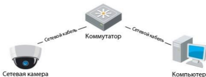
Рисунок 3-2 Соединение через коммутатор или роутер
