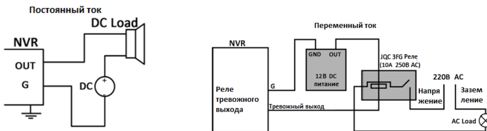
Рисунок 2.5 Подключение тревожного выхода
